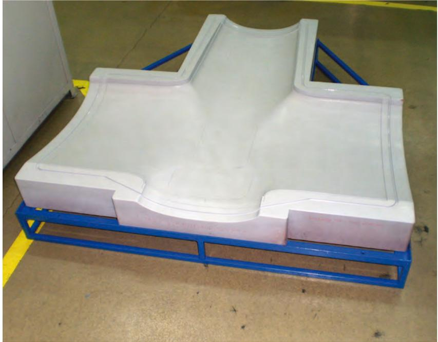
Molde para fabricação de peças em compósitos
